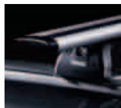
Упор (опора) багажника для автомобилей с интегрированными рейлингами (заподлицо).
