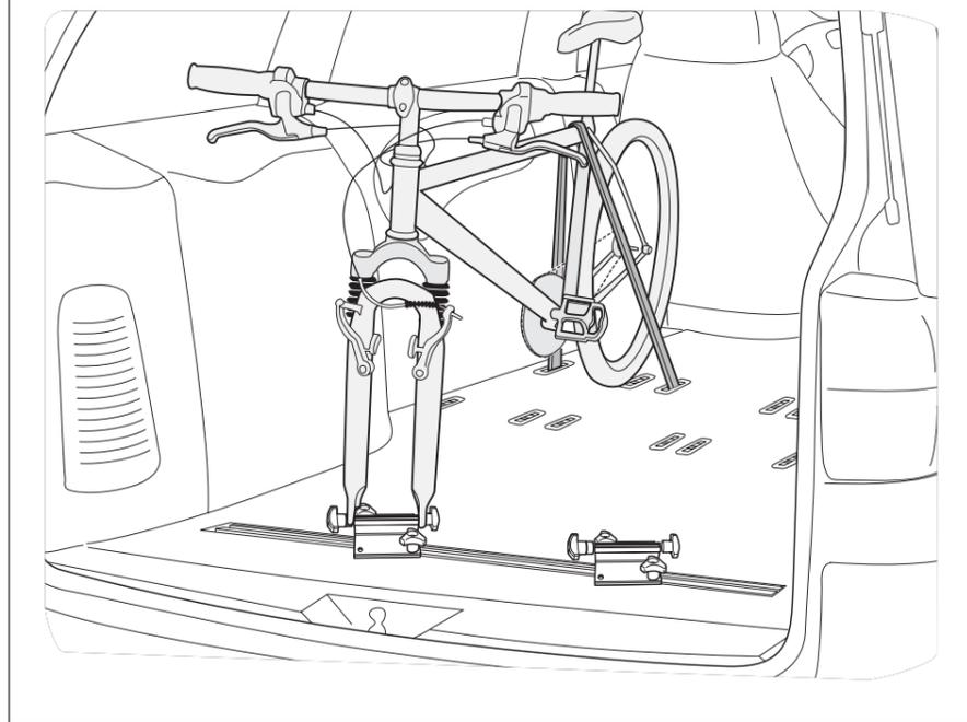
**S** Kontrollera skruvarnas och spännremmarnas åtdragning efter en kort körsträcka och gör regelbundna kontroller med lämpliga intervaller. Spännremmarna ska fästas så att cykeln dras nedåt. Annars kan framgaffeln lossna från cykelhållaren. **OBS!** Det är förbjudet att sitta på de stolar som ev. står bredvid cykelhållaren när cykel är monterad. (Godkännande enl. ECE 21). De demonterade framhjulen och annat bagage ska spännas fast med spännremmar.
